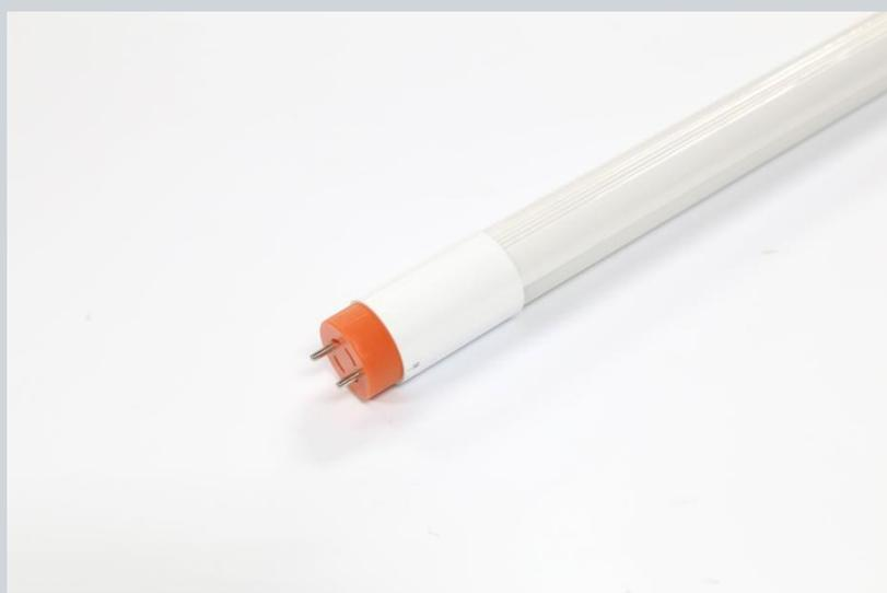
LED Leuchte in T8 Röhrenform. Ø26mm, verdrehbarer G13 Sockel, 85-265VAC, 50/60 Hz. Stabile Röhre aus Aluminium mit Plexiglas-Abdeckung aus PMMA. Überhitzungs-, Überspannungs- und Kurzschluss-Schutz.
